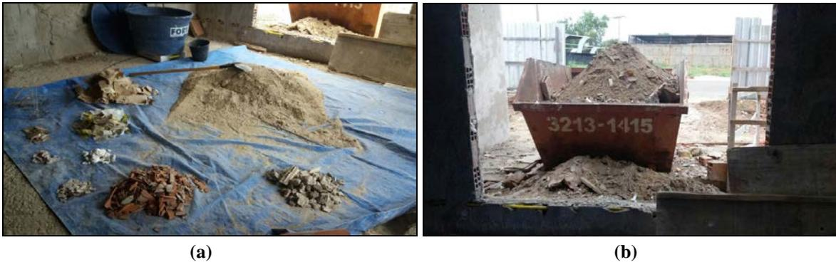
Figura 1: Determinação da composição gravimétrica de RCC. (a) Componentes segregados, materiais e equipamento utilizados; (b) Contêiner de armazenamento de RCC.
